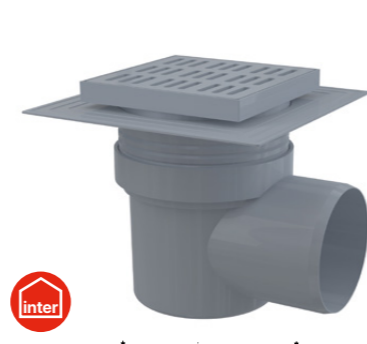
APV10 Podlahová vpust 150×150/110 mm boční, mřížka šedá, límec 2. úrovně izolace, vodní zápachová uzávěra
