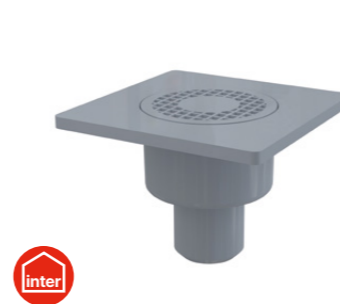
APV4 Podlahová vpust 150×150/50 mm přímá, mřížka šedá, vodní zápachová uzávěra
