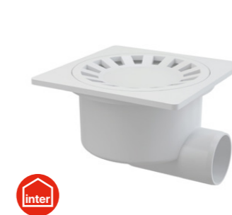
APV15 Podlahová vpust 150×150/50 mm boční, mřížka bílá, vodní zápachová uzávěra
