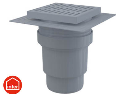
APV11 Podlahová vpust 150×150/110 mm přímá, mřížka šedá, límec 2. úrovně izolace, vodní zápachová uzávěra
