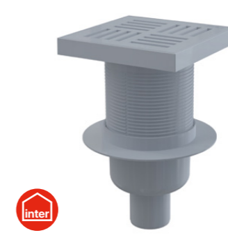
APV6211 Podlahová vpust 150×150/50 mm přímá, mřížka šedá, vodní zápachová uzávěra
