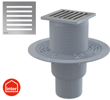
APV203 Podlahová vpust 105×105/50/75 mm přímá, mřížka nerez, vodní zápachová uzávěra
