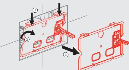
**5. Vyberte splachovací mechanizmus, ktorý ovláda tiahlo vypúšťacieho ventilu.**
