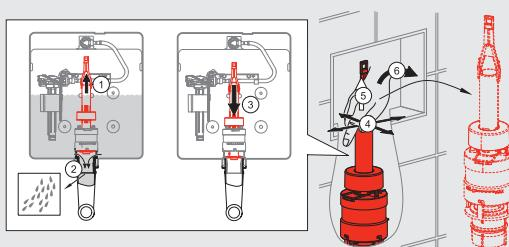
**9. Odstráňte nečistoty na dne nádržky.** Nádržku vypláchnite pomocou hadičky odpojenej od napúšťacieho ventilu
