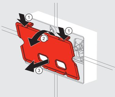
**2. Odstráňte celé tlačítko z WC modulu.** Najprv uvoľnite zámky služiace na zaistenie rámčeka tlačítok. Potom pomocou bočných svoriek uvoľnite samotné tlačítko a zložte ho.
