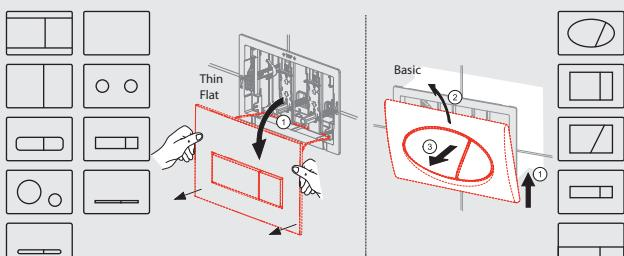
2. Odstráňte celé tlačítko z WC modulu. Najprv uvoľnite zámky služiace na zaistenie rámčeka tlačítok. Potom pomocou bočných svoriek uvoľnite samotné tlačítko a zložte ho.
