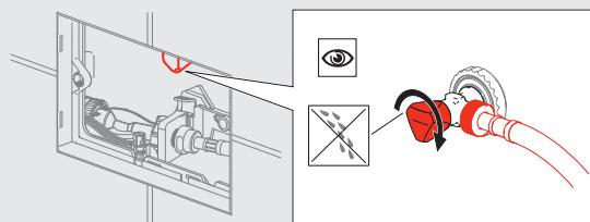
**7. Odpojte a vyberte napúšťací ventil. S vypúšťacím ventilem sa vám tak bude lepšie manipulovať.**
