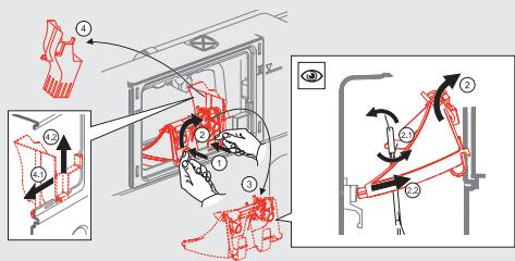
**6. Uzavrite prívod vody do WC modulu pomocou rohového ventilu.**
